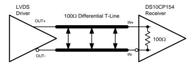
Figure 2. Typical LVDS Driver DC-Coupled Interface to DS10CP154A Input
