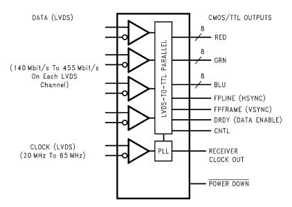
Figure 1. DS90CF384AQ Block Diagram
