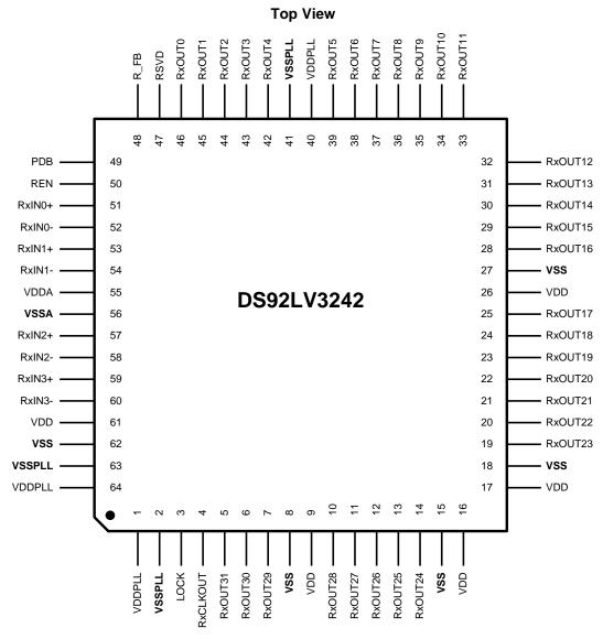
Figure 4. DS92LV3242 Pin Diagram 64-Pin TQFP (PAG Package)
