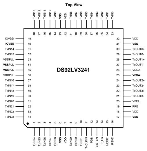
Figure 3. DS92LV3241 Pin Diagram 64-Pin TQFP (PAG Package)
