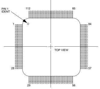
MOTOROLA DSP56166 112 CQFP PACKAGE PIN-OUT
