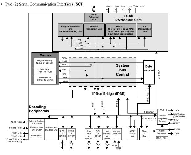
Figure 1. DSP56853 Block Diagram
