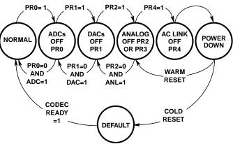
FIGURE 8. EXAMPLE OF SEQUENTIAL POWERDOWN
