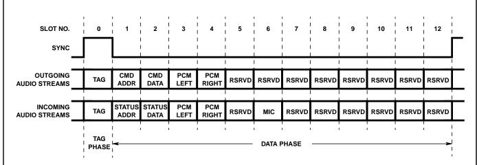
FIGURE 2. AC LINK BIDIRECTIONAL DATA FRAME
