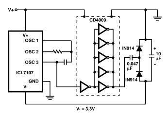
FIGURE 10. GENERATING NEGATIVE SUPPLY FROM +5V
