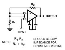
FIGURE 1C. NON-INVERTING AMPLIFIER
