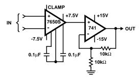
FIGURE 4. USING 741 TO BOOST OUTPUT DRIVE CAPACITY
