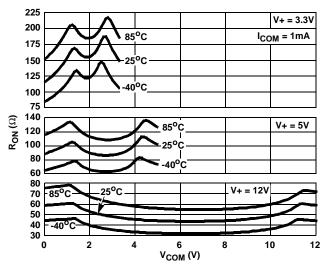
FIGURE 10. ON RESISTANCE vs SWITCH VOLTAGE
