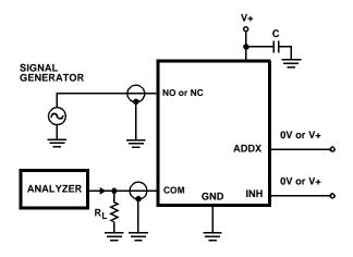
FIGURE 4. OFF ISOLATION TEST CIRCUIT
