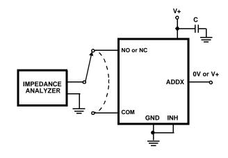
FIGURE 7. CAPACITANCE TEST CIRCUIT
