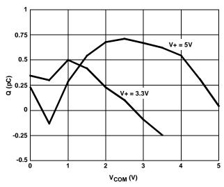
FIGURE 15. CHARGE INJECTION vs SWITCH VOLTAGE
