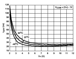
FIGURE 12. TURN - OFF TIME vs SUPPLY VOLTAGE
