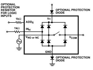
FIGURE 8. OVERVOLTAGE PROTECTION
