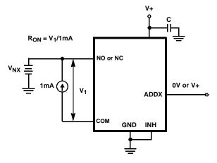
FIGURE 5. R<sub>ON</sub> TEST CIRCUIT
