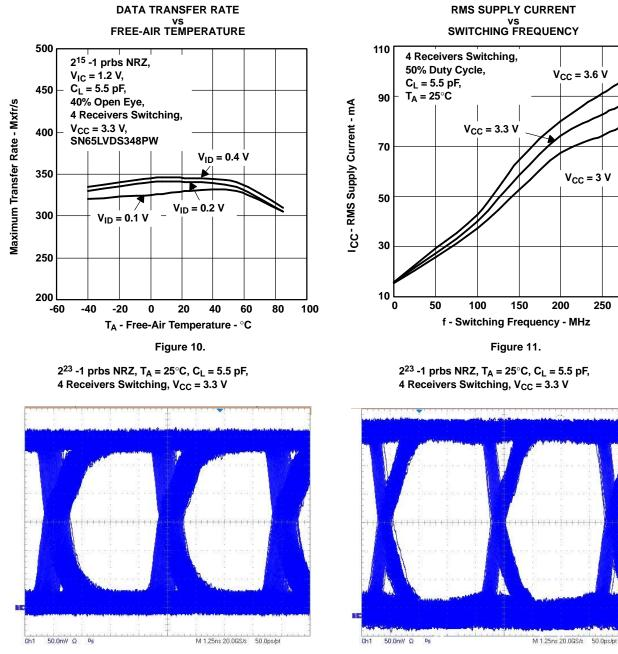
Figure 12. SN65LVDS348 Eye Pattern Running at 200 Mxfr/s
