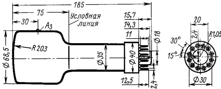
Осциллографическая трубка для визуальной регистрации электрических процессов.
