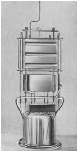
Abb. 2 Innenaufbau der Röhre KBC 1.
