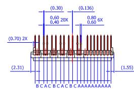
LEAD PITCH (TOLERANCE : ±0.30) A : 1.778 B : 2.050 C : 2.531
